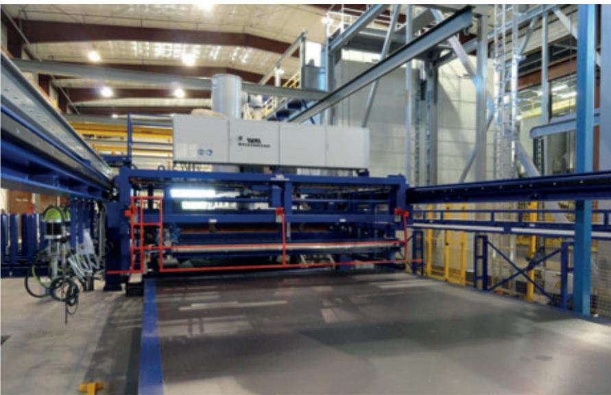
Na estação LPL (limpeza, plotagem, lubrificação) são baixadas as dimensões e posições das placas para componentes de um arquivo CAD para a plotadora automática e transferidas diretamente para a paleta limpa.
