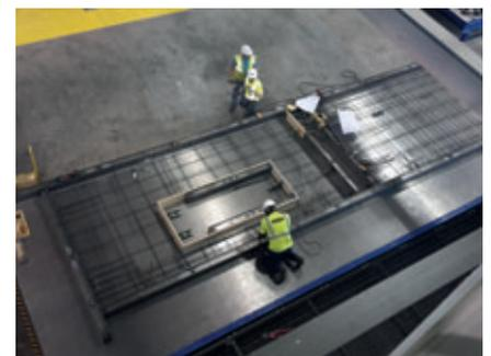
Assim que o contorno exterior é pré-determinado, os elementos de moldagem magnéticos são posicionados com um guindaste de manuseio operado manualmente. A figura 1 mostra a armazenagem dos elementos de moldagem em primeiro plano e, em segundo plano, o respectivo transporte. Assim que a forma é posicionada, os funcionários colocam a armadura pré-moldada, as âncoras de transporte e as tubulações.
