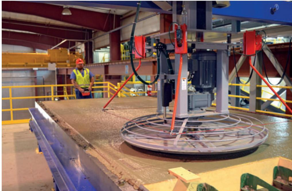
Depois de uma paleta ter começado a solidificar na câmara de cura, ela é transportada para a estação de alisamento. Esta é disposta por cima da câmara, de modo a economizar espaço na fábrica. Um funcionário opera o dispositivo de pás alisadoras com um controle remoto, que substitui os vários funcionários de uma instalação tradicional.
