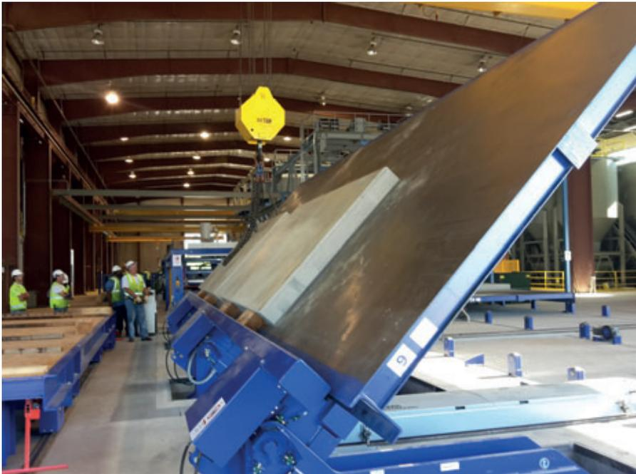
Após uma cura completa e desmoldagem, a mesa basculante é basculada a 70°, ou seja, praticamente na vertical. Isso evita tensões de flexão nas placas, que poderiam ocorrer se estas fossem levantadas da posição horizontal para a vertical. Na Molin, as placas são desmoldadas, armazenadas e enviadas na vertical.
