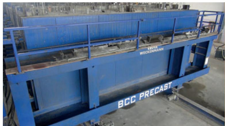
Одна из двух кассетных опалубок для производства внутренних и наружных стеновых панелей
