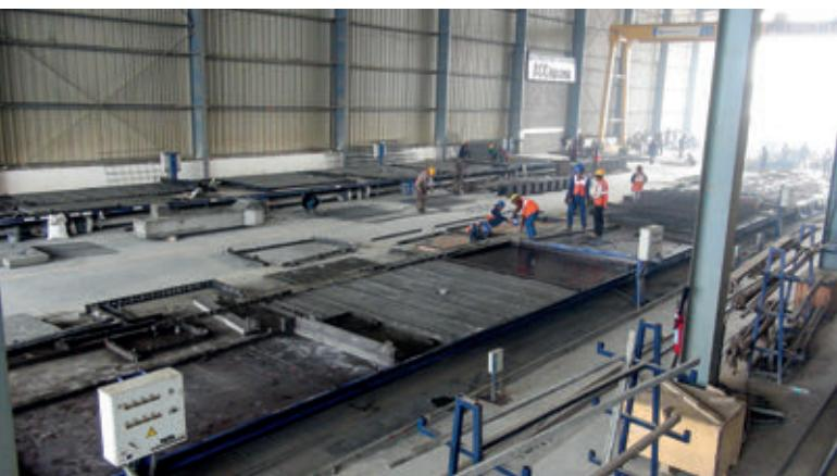
Производство плит перекрытия и специальных элементов на линии Weckenmann в Бхарат-Сити, Индия
