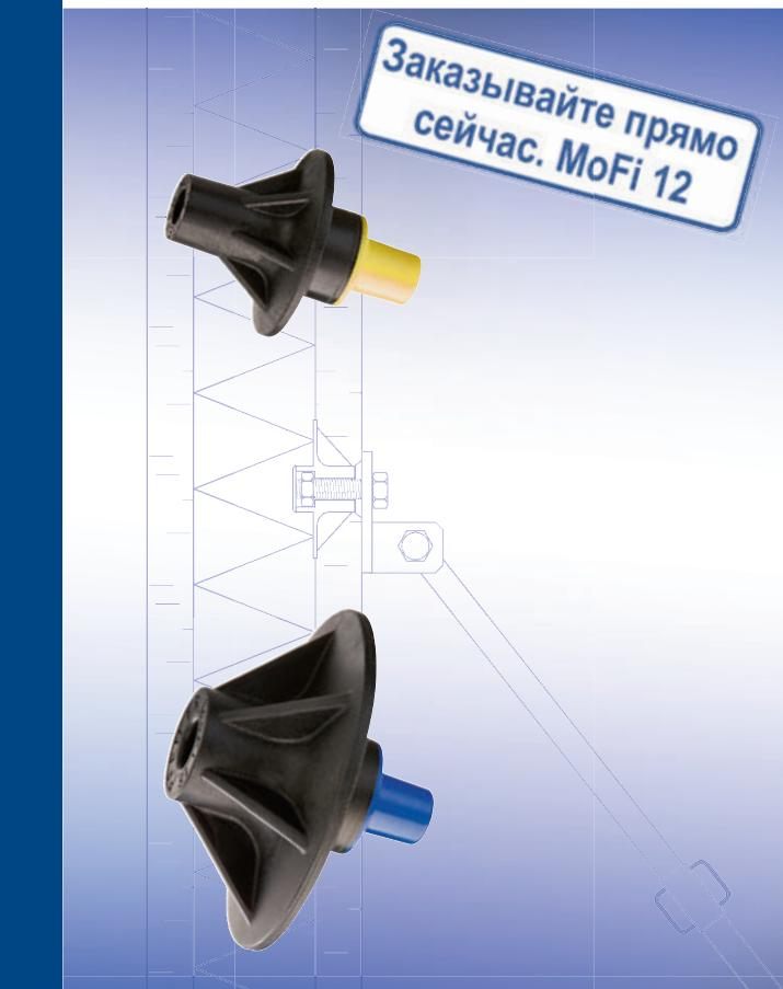
Система крепления наклонных опор MoFi от компании Pfeifer предназначена для фиксации наклонных опор на сборных бетонных элементах во время монтажа бетонных элементов. Анкерное крепление выдерживает временно возникающие нагрузки, как, например, порывы ветра.
