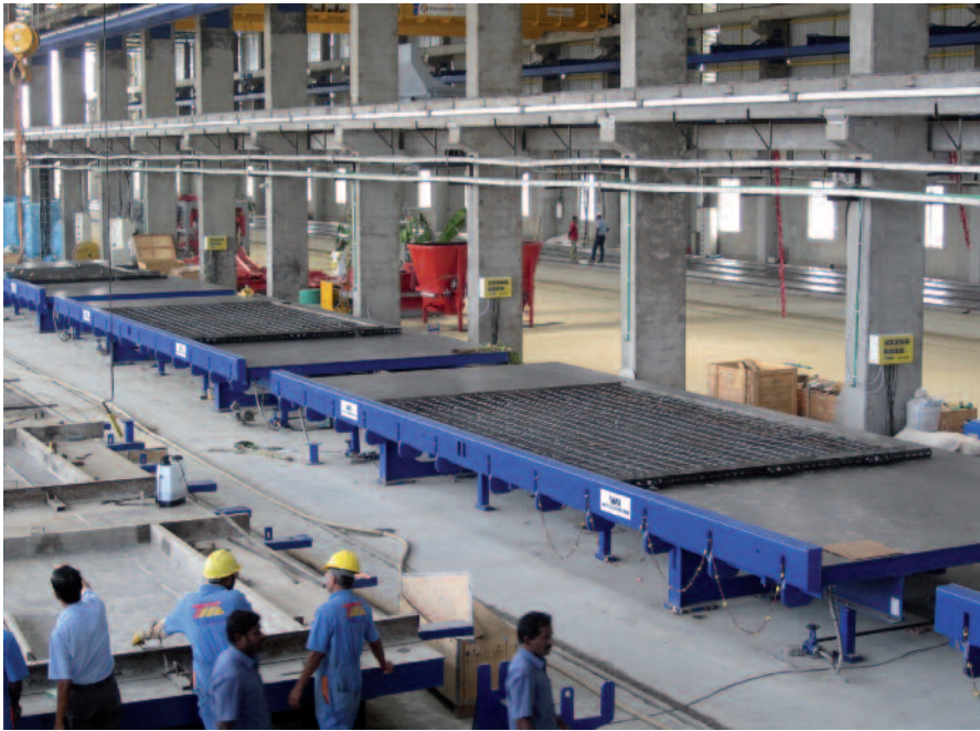
Quatro mesas basculantes de 4.5 m x 12.5 m feitas de precisas placas de aço para a otimização das superfícies de concreto aparente dos elementos pré-moldados
