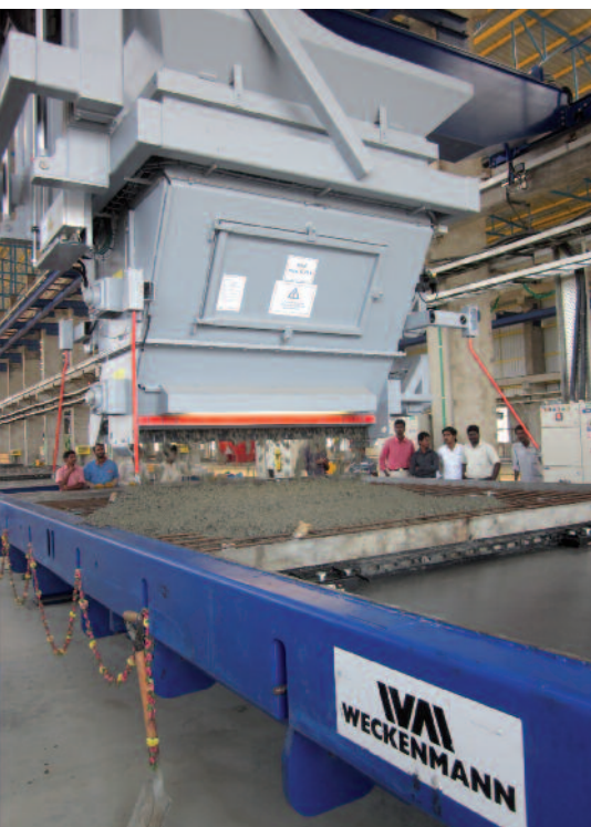
Um distribuidor de concreto com garantias de artes de elevação e distribuição integradas e com extrema precisão
