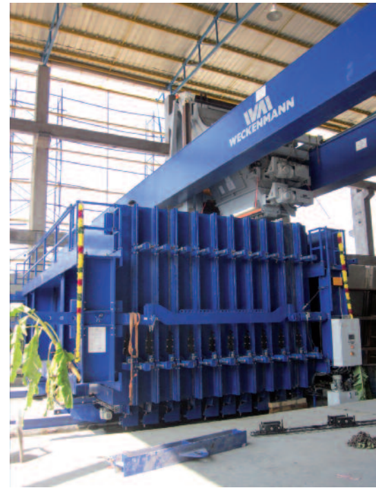
As paredes interiores e muros de divisa são produzidos em moldes de bateria
