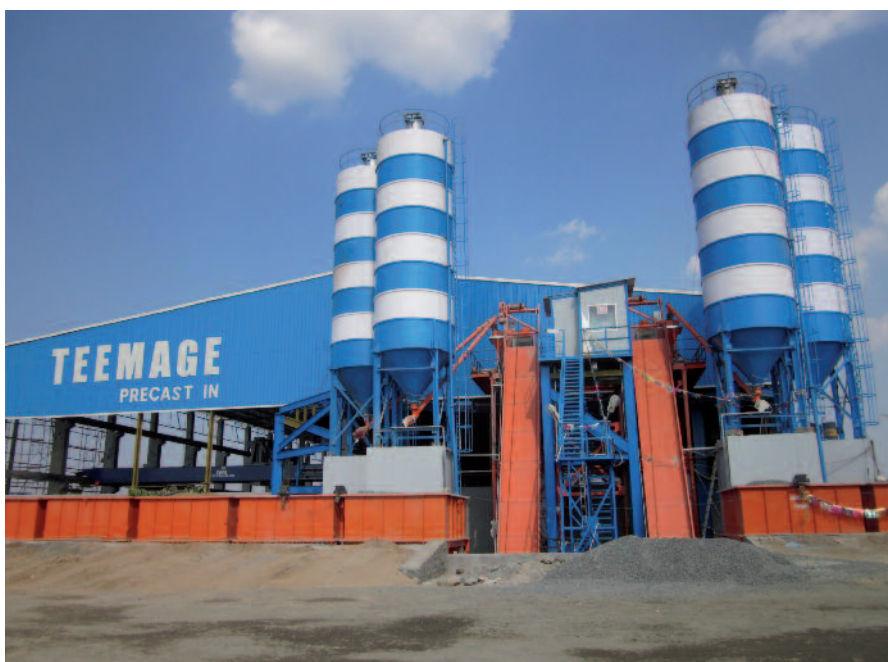
Com dois misturadores, cada um com capacidade de 1.5 m 3 , a instalação de mistura Teemage Precast produz mais de 90 m 3 /h de concreto, que são utilizados tanto para a produção de elementos pré-moldados quanto para concreto usinado
