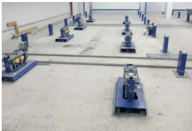
Высокочастотные вибраторы с магнитами на станции виброуплотнения MagVib
