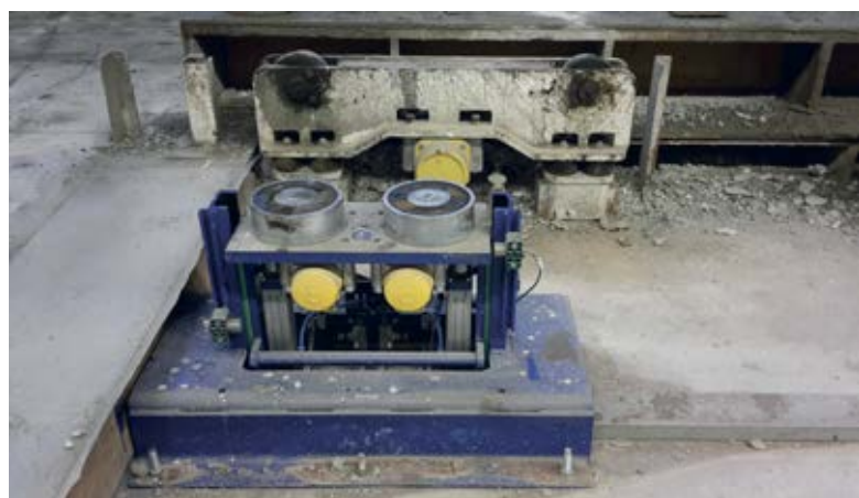
MagVib – высокочастотный вибрационный блок (синего цвета), на заднем плане – старая вибрационная рама
