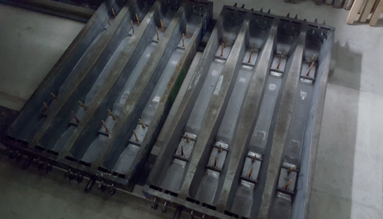
Moule à quatre cavités de la traverse de chemin de fer B70.
