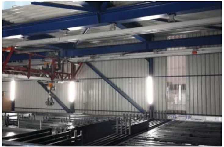
Новый накопитель фирмы Weckenmann с расширенным накопителем и новыми шаговыми роликовыми конвейерами
