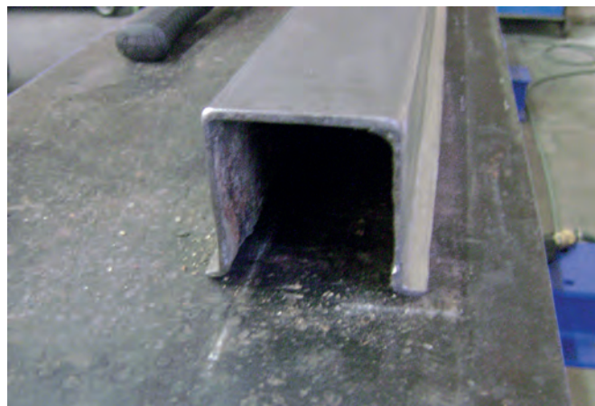
После ремонта: опалубка как новая – выровнена и функционально оптимизирована
