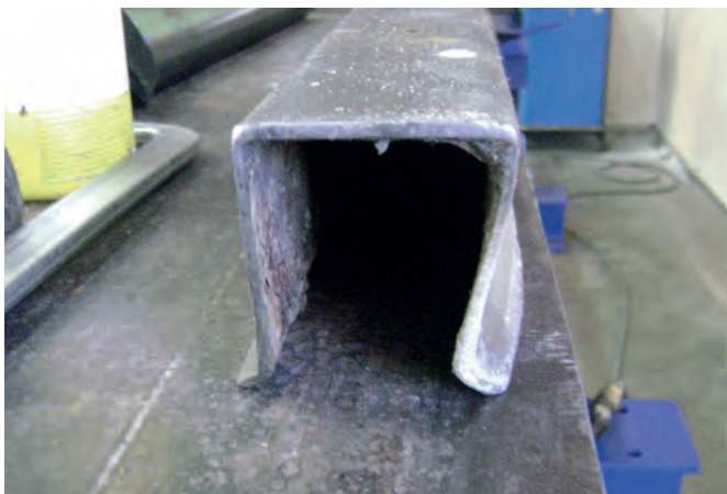
Опалубочные системы перед ремонтом: деформированная и измятая опалубка
