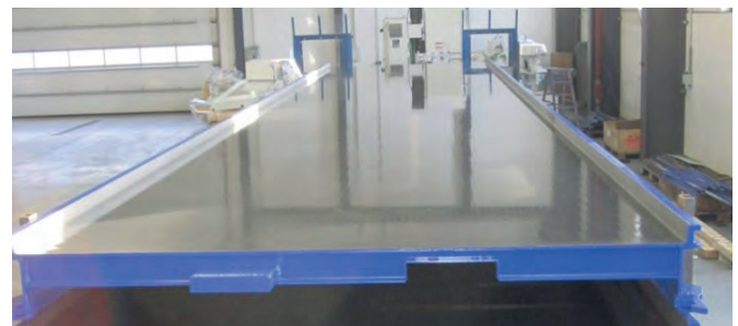
После ремонта: целная выровненная и ошлифованная опалубочная поверхность выглядит как новая
