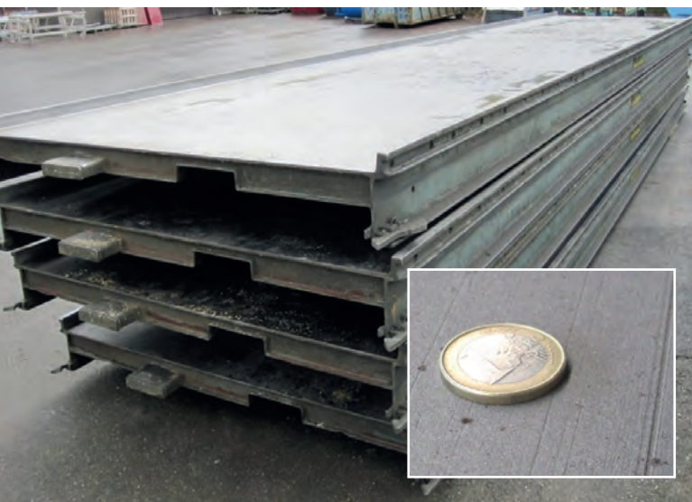
Опалубочная поверхность до ремонта: глубокие борозды и неровности; неудовлетворительное покрытие
