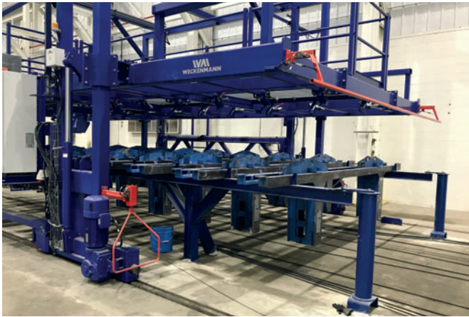
Carro manipulador (tirar cordones, manipular encofrados transversales)
