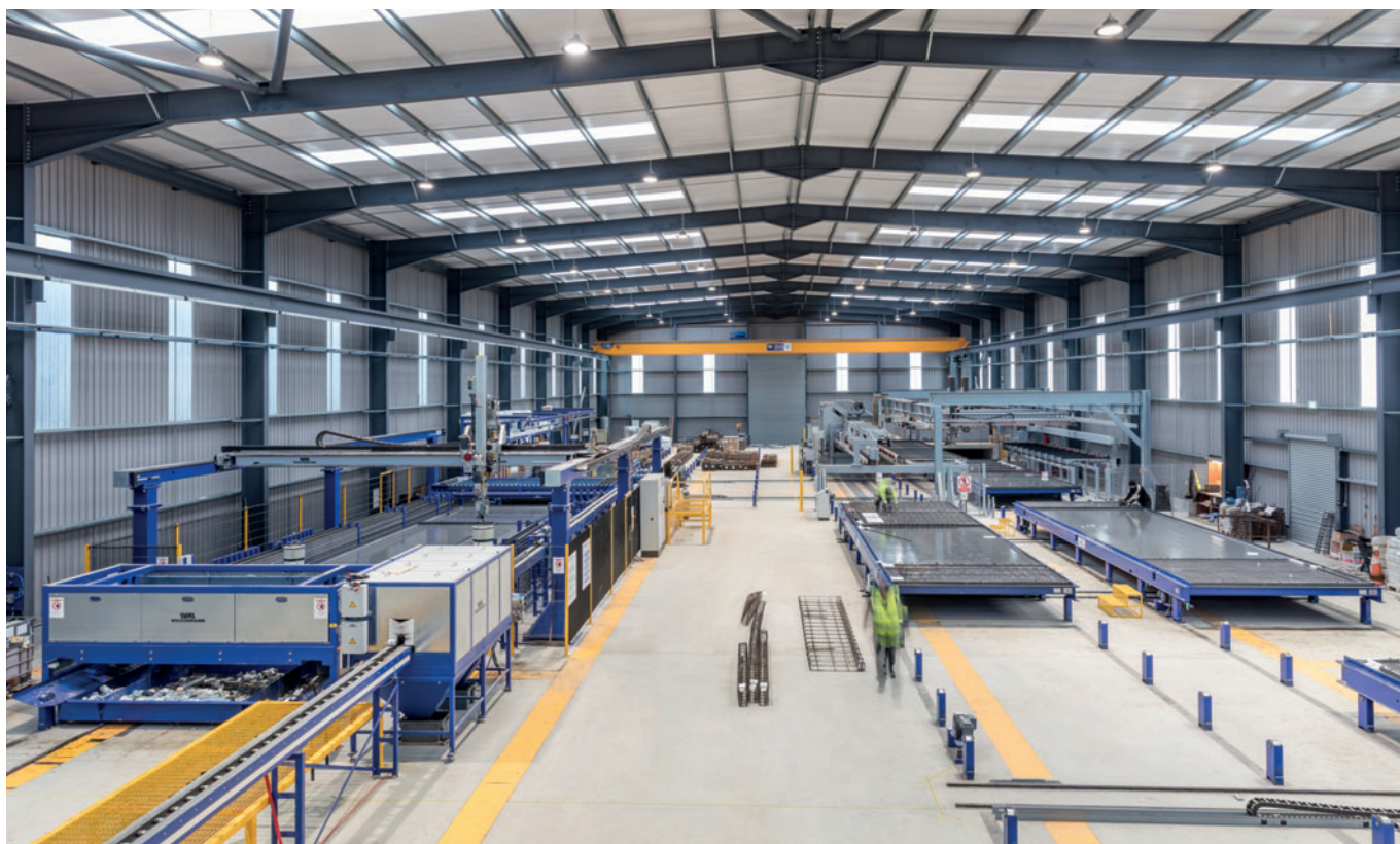
Линия оборотных поддонов на заводе компании Keegan Precast в Ирландии
