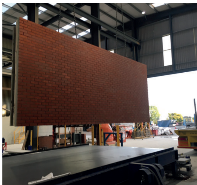
Готовый ж/б элемент с облицовкой
