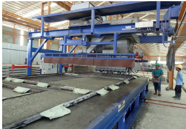
Distribuidor de hormigón en acción
