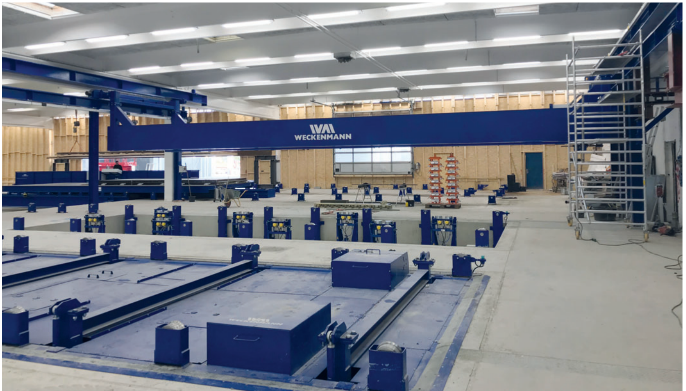
Станция виброуплотнения Weckenmann и вибротехнология MagVib
