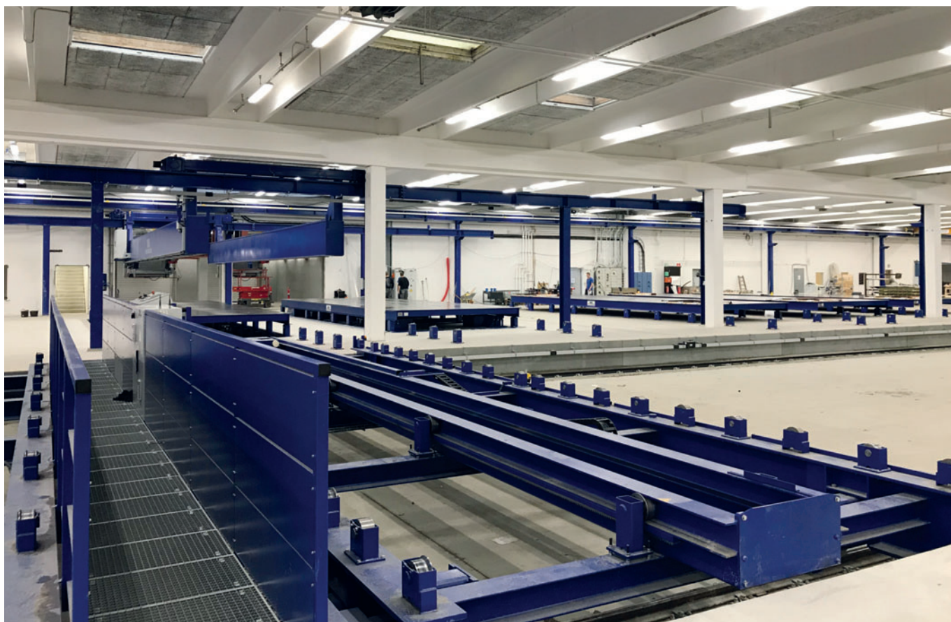
Центральная сдвижная платформа со сдвоенной площадкой
