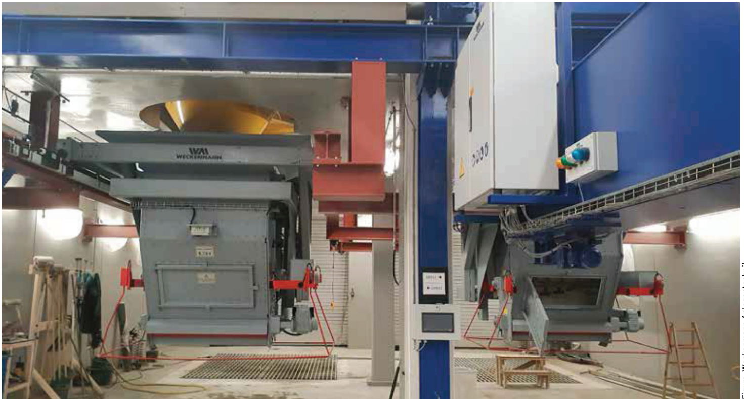
Concrete spreader with two buckets Betonverteiler mit zwei Kübeln
