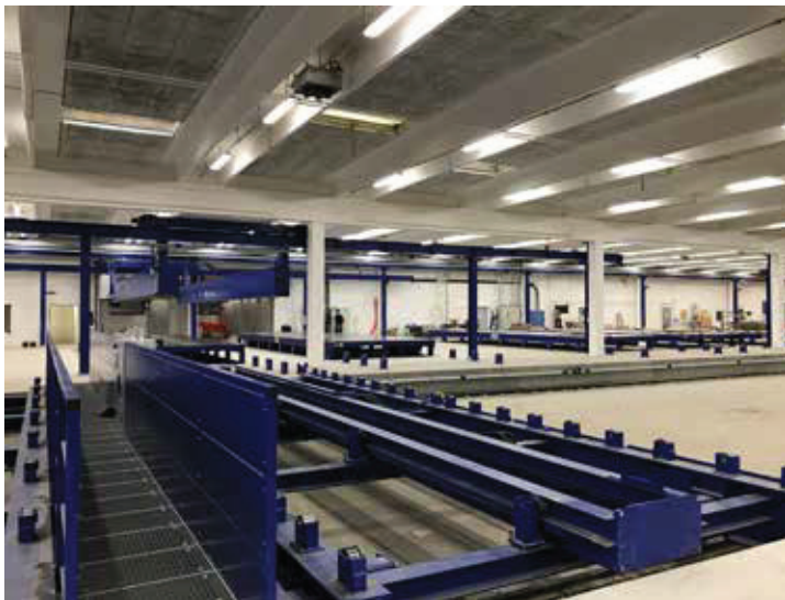
Central transport system with double platform Zentrale Schiebebühne mit Doppelplattform
