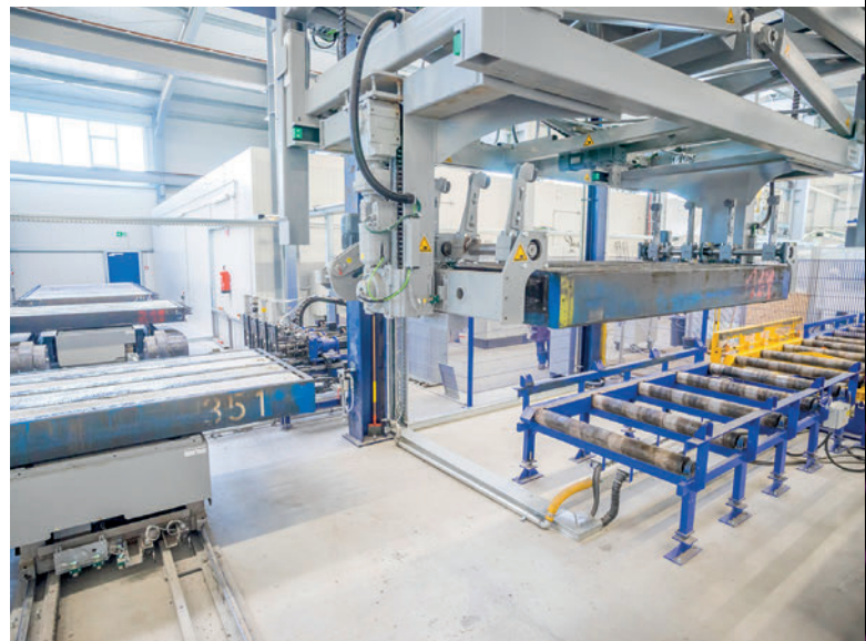
Estación de desencofrado
