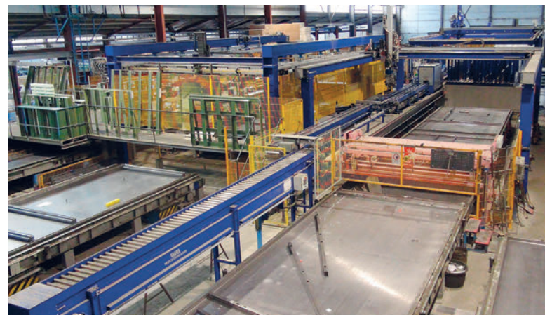
Abb. 2: Gesamtsystem mit Magnetboxen-Handling, Entschalungs-/Einschalungsroboter (auf einer Position), mit Paletten- und Schalungsreinigung, Magazinierungsroboter und Einbauteilsetzroboter
