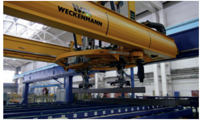
Le robot de coffrage Twin-Z convainc également par sa rapidité
