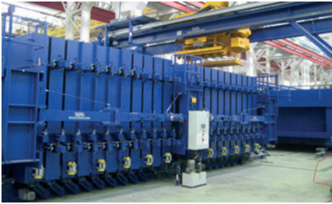
Les batteries de coffrage conviennent idéalement pour la fabrication, sur un espace restreint, d'éléments de paroi qui nécessitent deux surfaces lisses.
