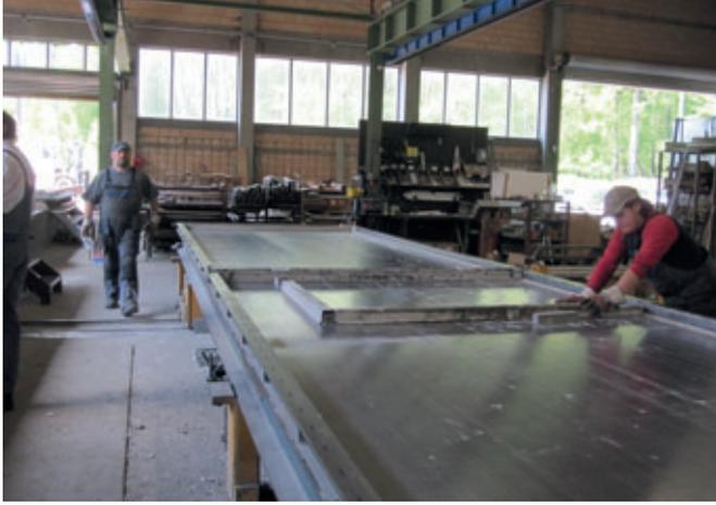
*Avant : coffrages et aimants séparés, stockage des coffrages et éléments incorporés ainsi que des outils – pistolets à colle, etc. – sur la face frontale de la palette, entraînant des trajets plus longs. Nettoyage manuel des coffrages et aimants.*
