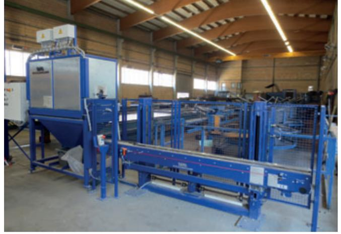
*Après : système de manutention des coffrages avec dispositif de nettoyage / huileur pour les coffrages de bord avec aimants intégrés. Nettoyage / huilage automatiques des coffrages de bord et transport de ces derniers directement de l'emplacement de décoffrage à l'emplacement de coffrage.*
