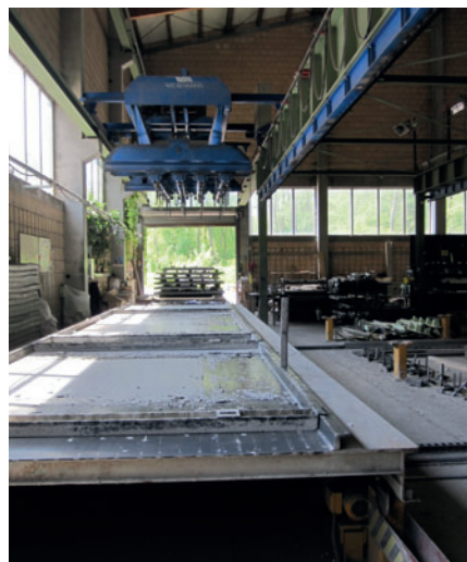
До: распалубка на одной позиции в один штабель с одной разгрузочной тележкой
