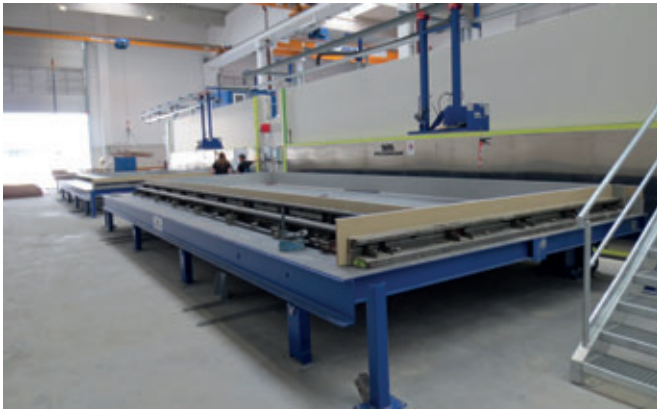
Estaciones de encofrado con proyección láser
