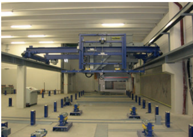
Distribuidor de hormigón
