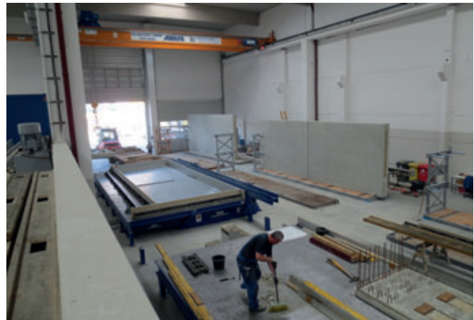
Área de desencofrado
