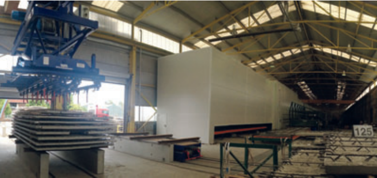
Cuatro puntos de apilado para prelosas armadas con dos carros de salida en funcionamiento semiautomático
