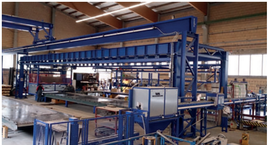
Fluxo de trabalho eficaz e ergonômico através de um sistema de transporte de moldes com limpador e lubrificador e disponibilidade confiável do sistema por meio de máquinas novas
