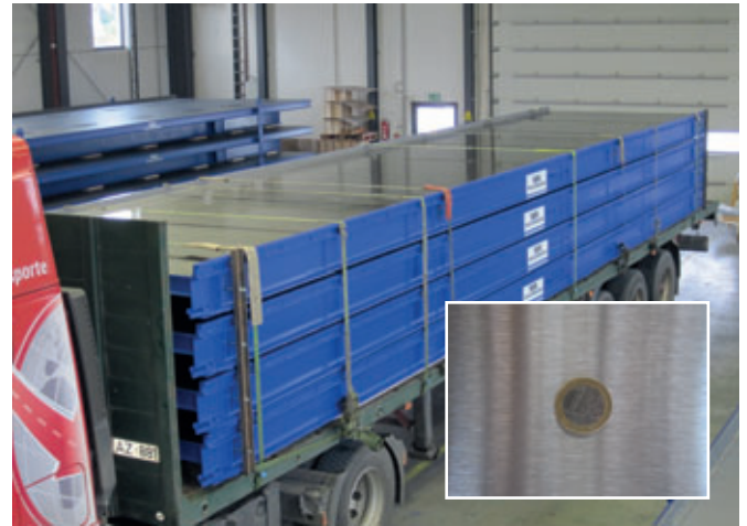
... e depois da renovação pela Weckenmann: Superfícies visíveis jateadas e pintadas e a superfície do molde lixada para altas qualidades do concreto pré-moldado
