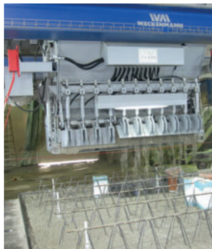
À esquerda: distribuição desigual de concreto, posição de deslocamento do operador. À direita: Descarga precisa e uniforme de concreto com um novo distribuidor de concreto da Weckenmann
