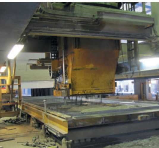
À esquerda: distribuição desigual de concreto, posição de deslocamento do operador. À direita: Descarga precisa e uniforme de concreto com um novo distribuidor de concreto da Weckenmann
