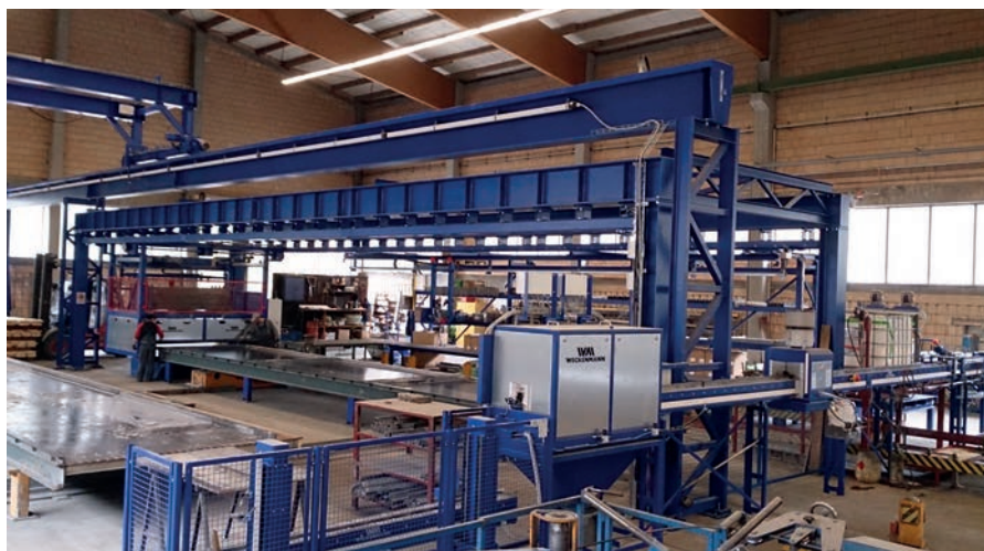
Эффективные и эргономичные производственные процессы с использованием опалубочного конвейера с чистящими и смазывающими модулями, а также надежная работа всей установки за счет новых станков
