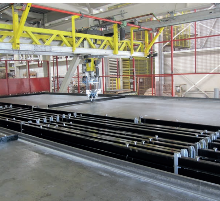
Модернизация с использованием опалубочного робота и магнитной опалубки
