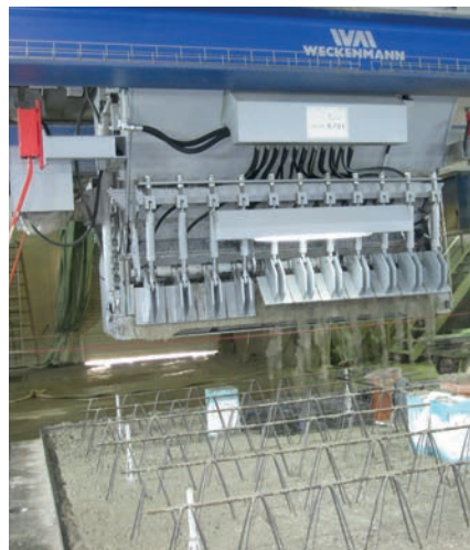
Слева: неравномерное распределение бетона. Справа: точная и стабильная раздача бетона при помощи нового бетонораздатчика Weckenmann
