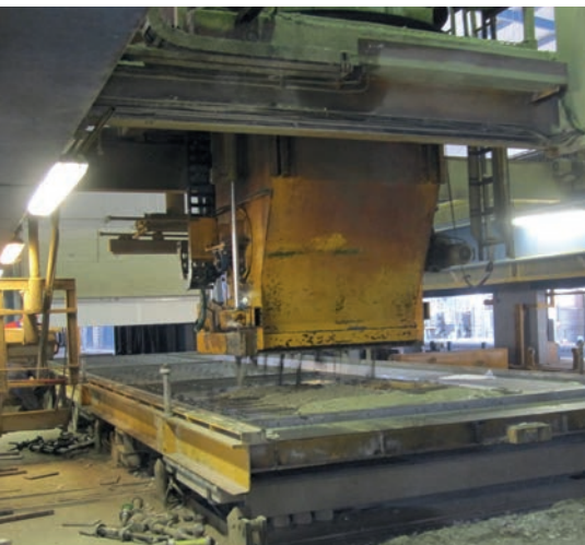
Слева: неравномерное распределение бетона. Справа: точная и стабильная раздача бетона при помощи нового бетонораздатчика Weckenmann
